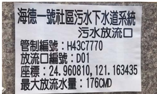
標示放流口告示牌
