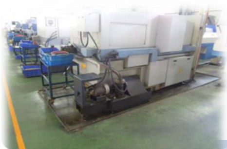
為避免製程機具之潤滑油品滴落地面 將機具置於大尺寸盛油盆上
