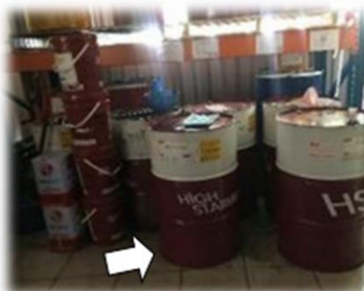
油品桶槽置於地面
