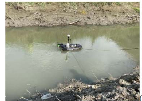
二仁溪崇德橋量測情況 (a)流量及河道斷面測量 (b)聲波都普勒流速儀
