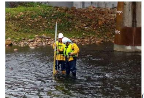
南崁溪龜山橋量測情況 (a)斷面高程測量 (b)流速水位測量
