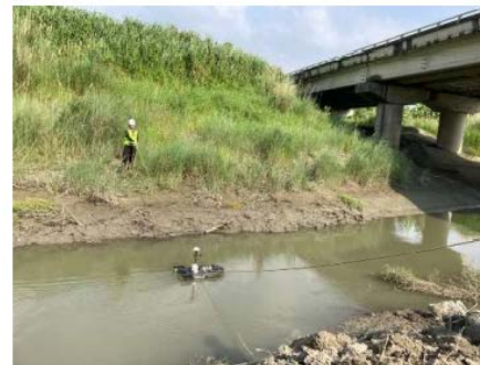
二仁溪崇德橋量測情況 (a)流量及河道斷面測量 (b)聲波都普勒流速儀
