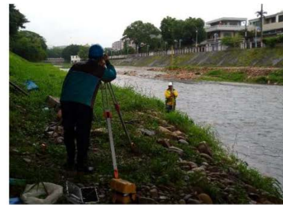
南崁溪龜山橋量測情況 (a)斷面高程測量 (b)流速水位測量
